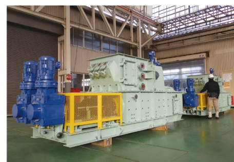
焼却溶解設備 給じん装置
