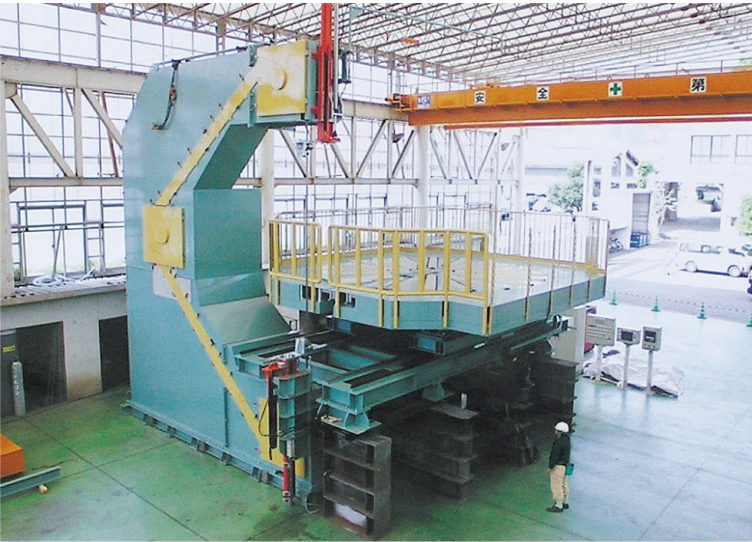
大型切断装置 業界：自動車 寸法：7.9m×10m×6m 材質：SS400 重量：92t
