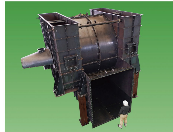
ケーシング 業界：建設 寸法：5.4m×4m×7m 材質：SM400・SS400 重量：5t
