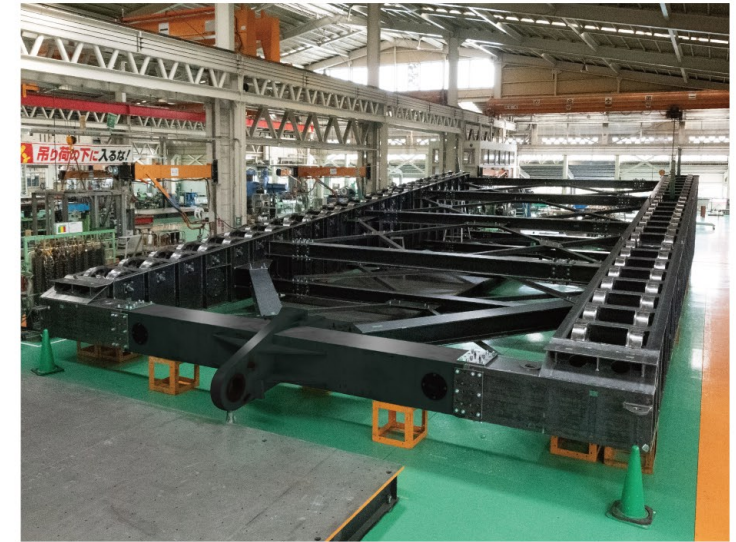
進水台車 業界：港湾 寸法：17m×9m 材質：SM400・SS400 重量：72t
